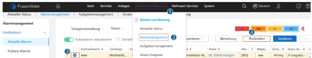
Wechseln Sie zum Eigentümerkonto mit Berechtigung für das PV-Anlagenmanagement. Klicken Sie auf der Startseite auf den Namen der PV-Anlage, um die Seite der PV-Anlage aufzurufen und klicken Sie nach Aufforderung auf **Bestätigen**, um den Alarm zu löschen.
